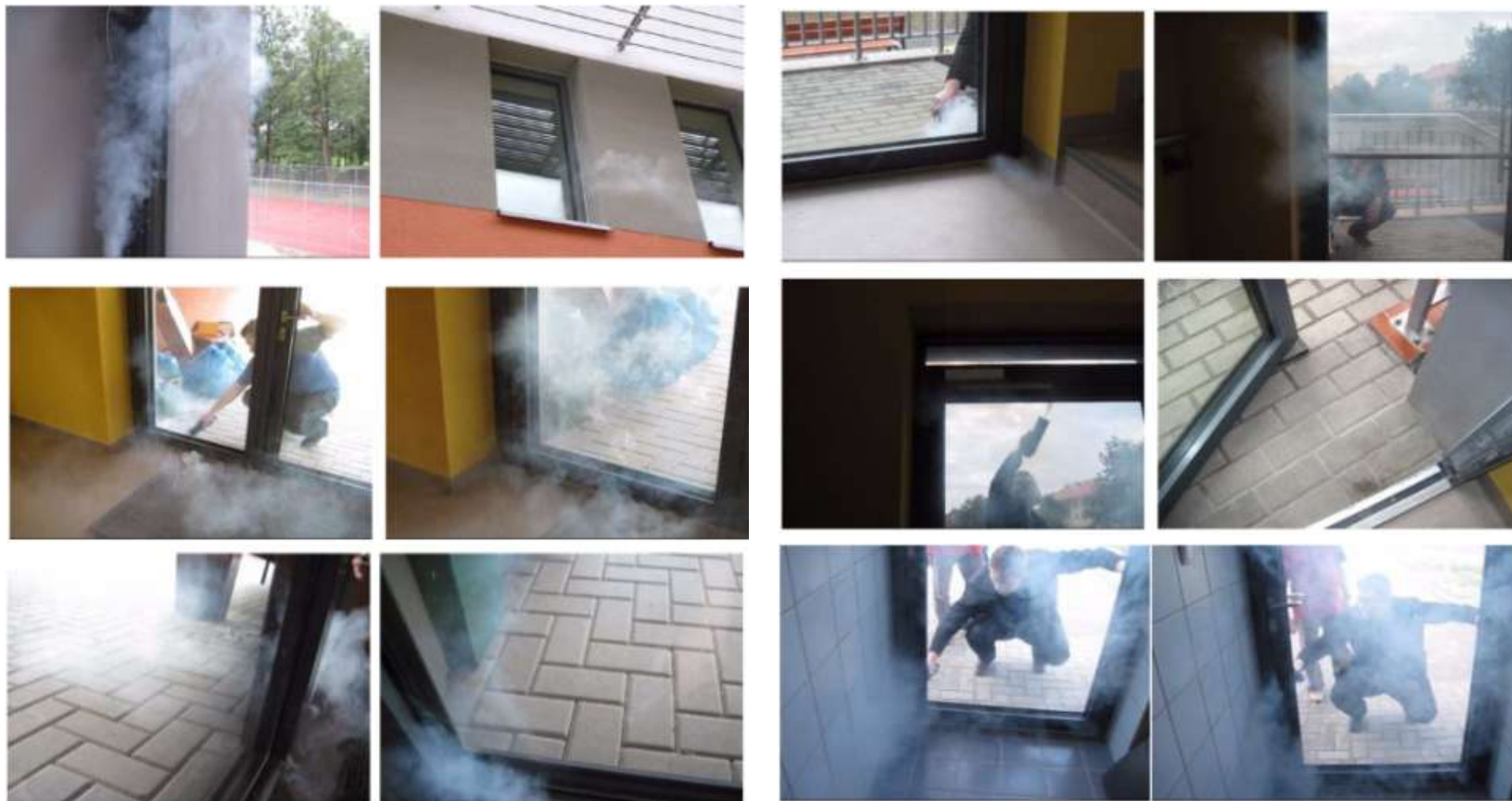
Nieszczelności na uszczelkach między skrzydłem a ramą stolarki okiennej i drzwiowej
