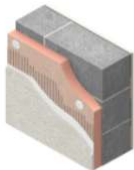
Ściana od zewnątrz – Kooltherm
