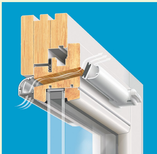
Rys. 2. Nawiewnik sterowany ciśnieniowo w oknie drewnianym
