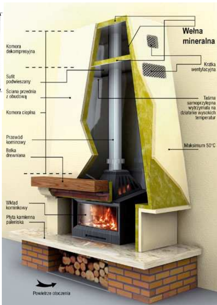
Rys. 14.2. Przekrój przez kominek z zamkniętą komorą spalania [55]:
