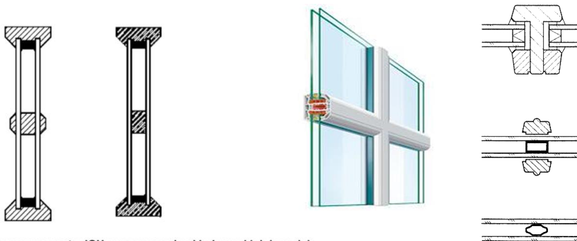
Rysunek J.2 – Szpros pojedynczy wewnątrz IGU ze szprosami nakładanymi lub bez nich
