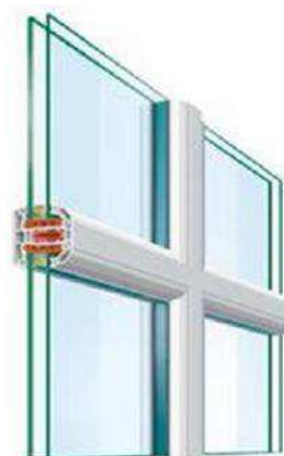
Rysunek J.3 – Wiele szprosów wewnętrznych w IGU ze szprosami nakładanymi lub bez nich
