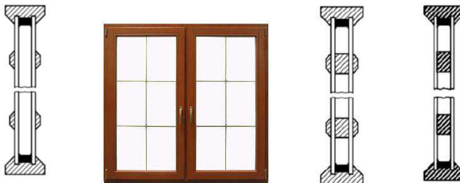
Rysunek J.1 – Szpros (szpros) nakładany (nakładane)
